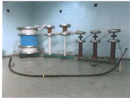
A2: 样品交流耐压试验
